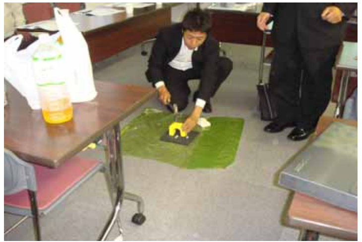
(ハンマーによる打撃試験:塗装したことによって供試体強度が2倍以上を確認)
