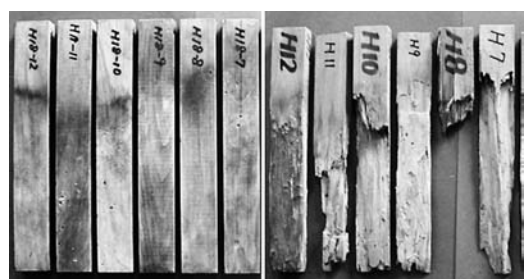
図8 DMDHEU処理(左)と無処理(右)ヒノキ杭の劣化状況
