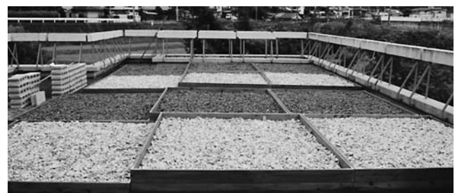
図8 屋上敷設資材としての性能評価試験
