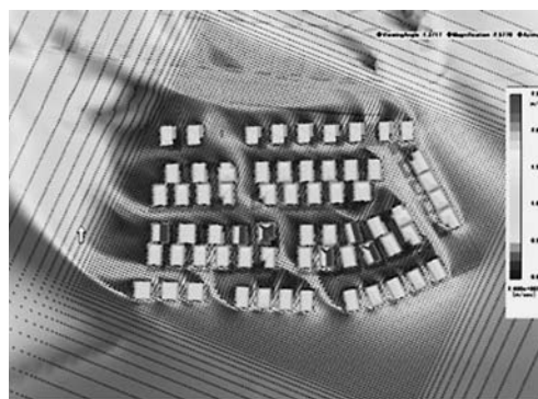
【図1 街区の風の流れをシミュレーションした図】
