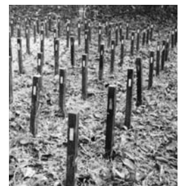
図2 素材の耐朽性評価試験（左）室内ビン試験、（右）野外杭試験
