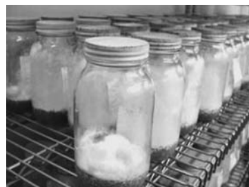
図2 素材の耐朽性評価試験（左）室内ビン試験、（右）野外杭試験
