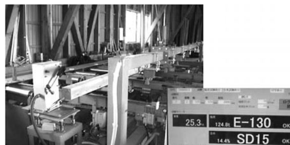
図7 グレーディングマシンでのヤング係数の測定
