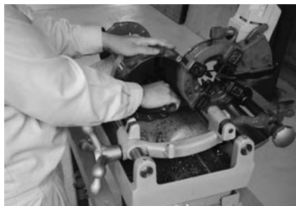
配管加工（ねじ切り）
