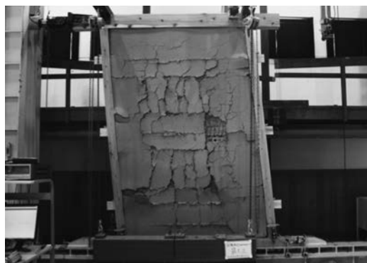
写真4 土壁試験体の破壊の様子（上：寺院建築仕様で貫厚を大きくして土壁を貫で分断したもの／下：民家仕様）
